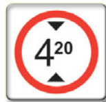
Altura libre restringida
